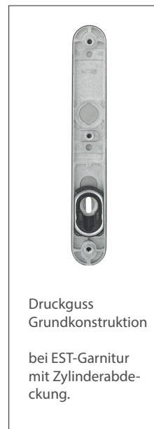
Seitliche Rastnasen zum Aufklipsen der Deckschilder gewähren eine stabile, flächenbündige Fixierung auf dem Grundschild.
